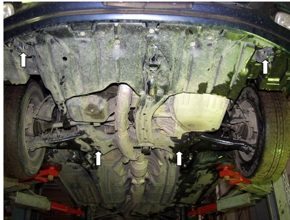
1. Закрепить поддон 1 спереди к проушинам автомобиля, болтами 2, с шайбами 3 и гайками 4 (А), сзади закрепить под штатные болты (В).
