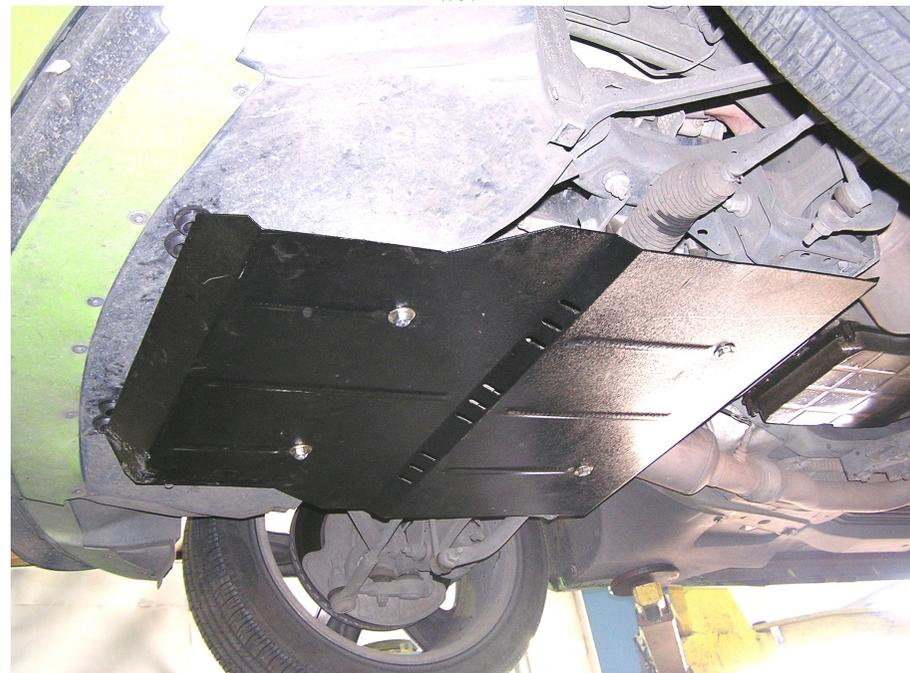
1. Снять штатный пыльник и штатный крепеж.
