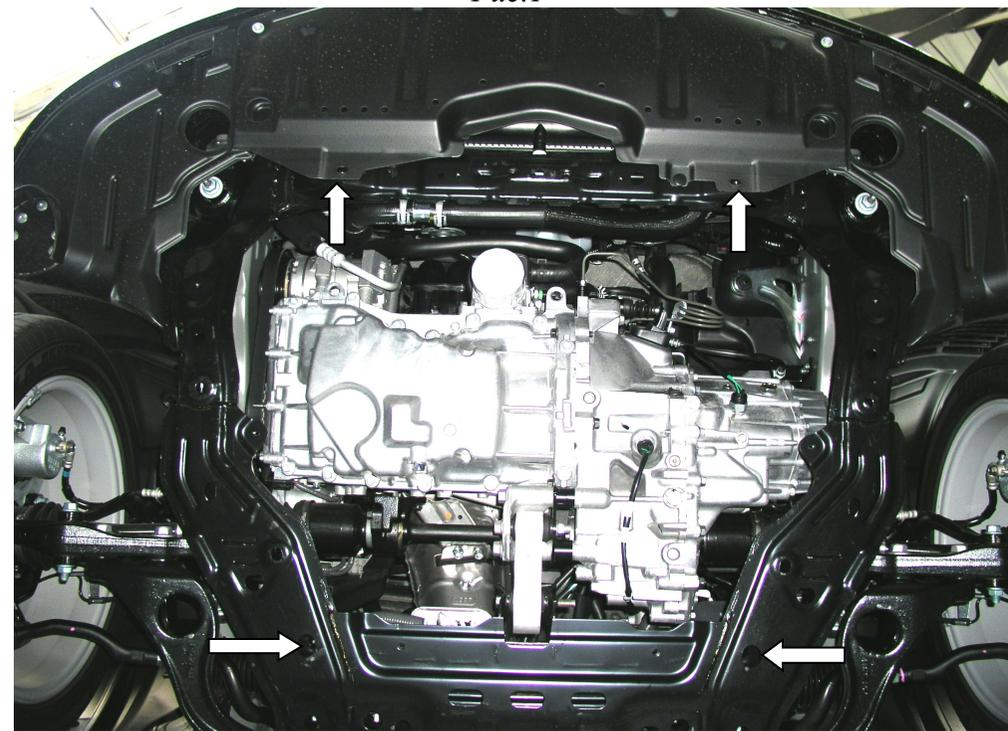
1. Снять штатный пыльник моторного отсека.
