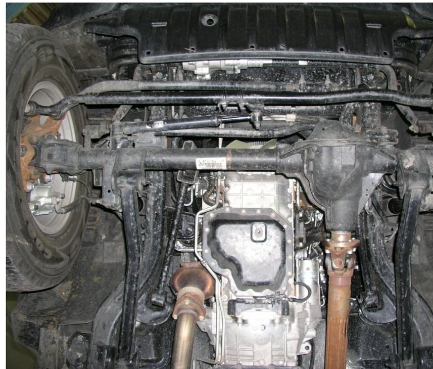
1. Снять штатный пыльник.
