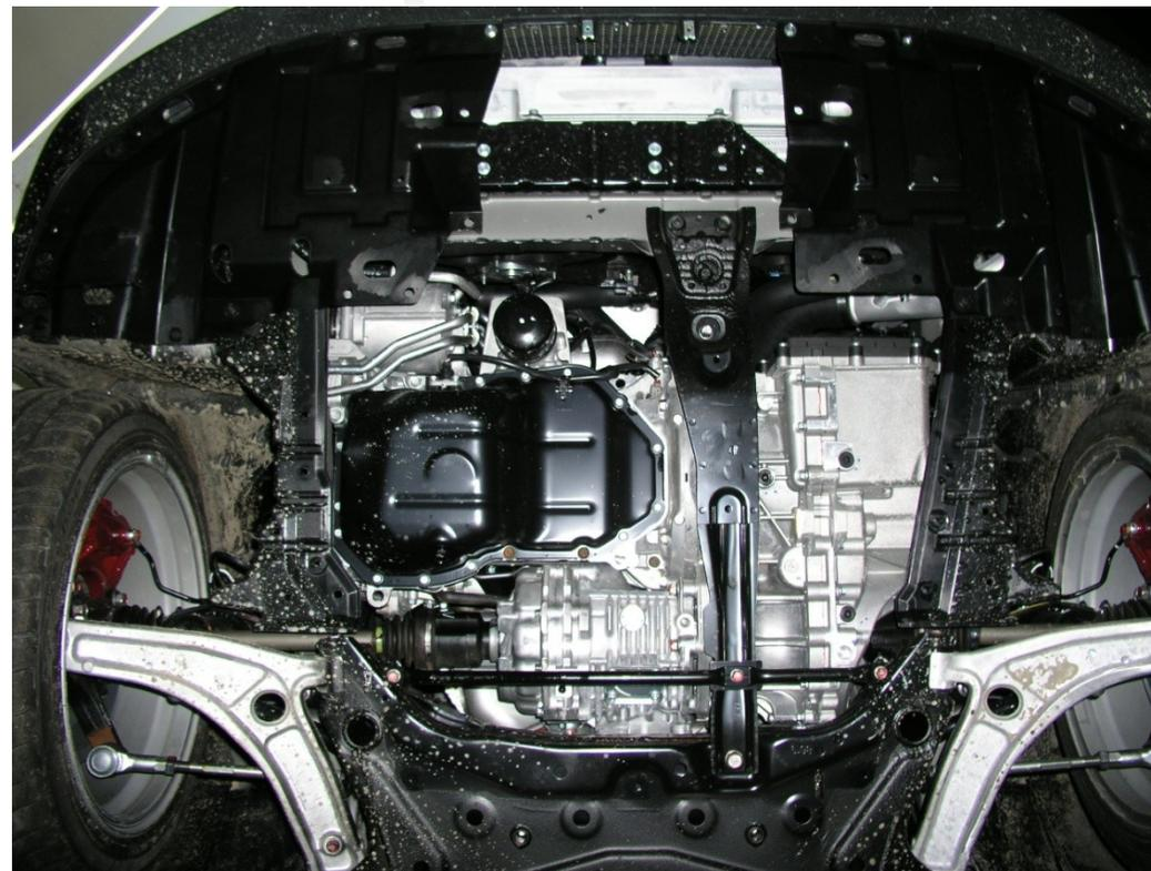
1. Снять центральную часть пластикового пыльника.
