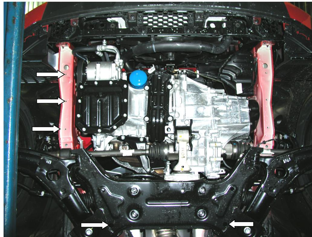
1. Снять два боковых штатных пыльника.
