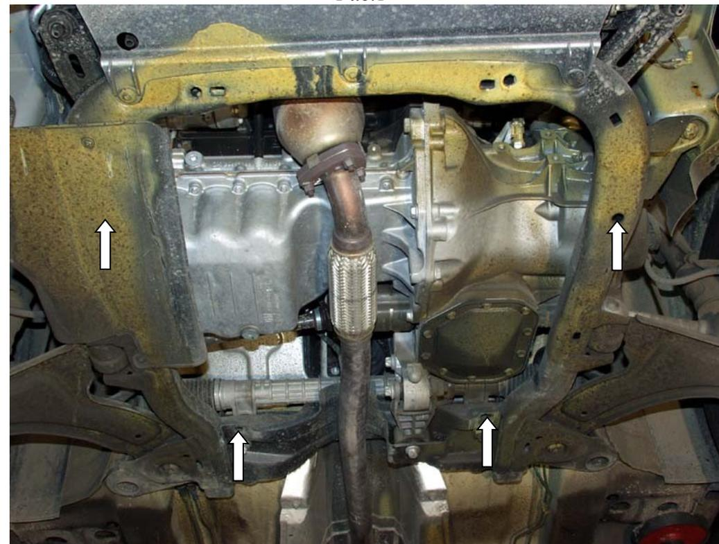
1. Наложить планки 6 над задними отверстиями балки двигателя и наживить болты 4.
