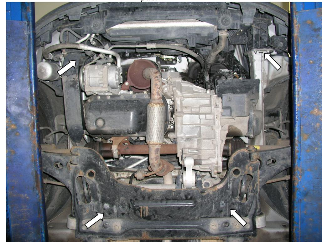
1. Закрепить балку 2 к силовым элементам лонжеронов, выкрутив штатные болты, рис.1,2.
