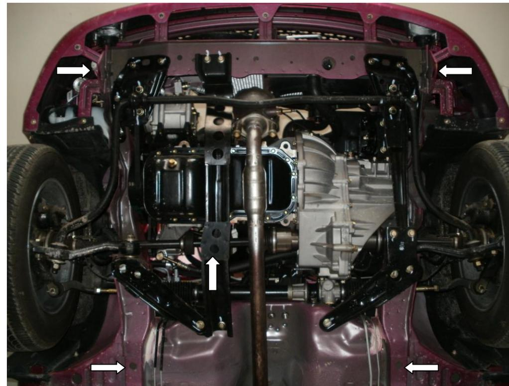
1. Прикрутить балку 2 справа и слева к транспортировочным проушинам автомобиля болтами 4.
