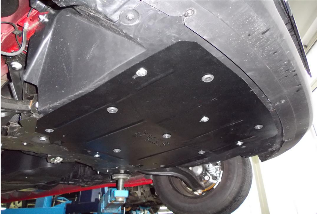
Защита закрывает двигатель, КПП.
