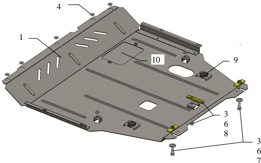
**ВНИМАНИЕ!!!** После монтажа защиты не допускается соприкосновение элементов защиты с движущимися элементами узлов и агрегатов автомобиля.
