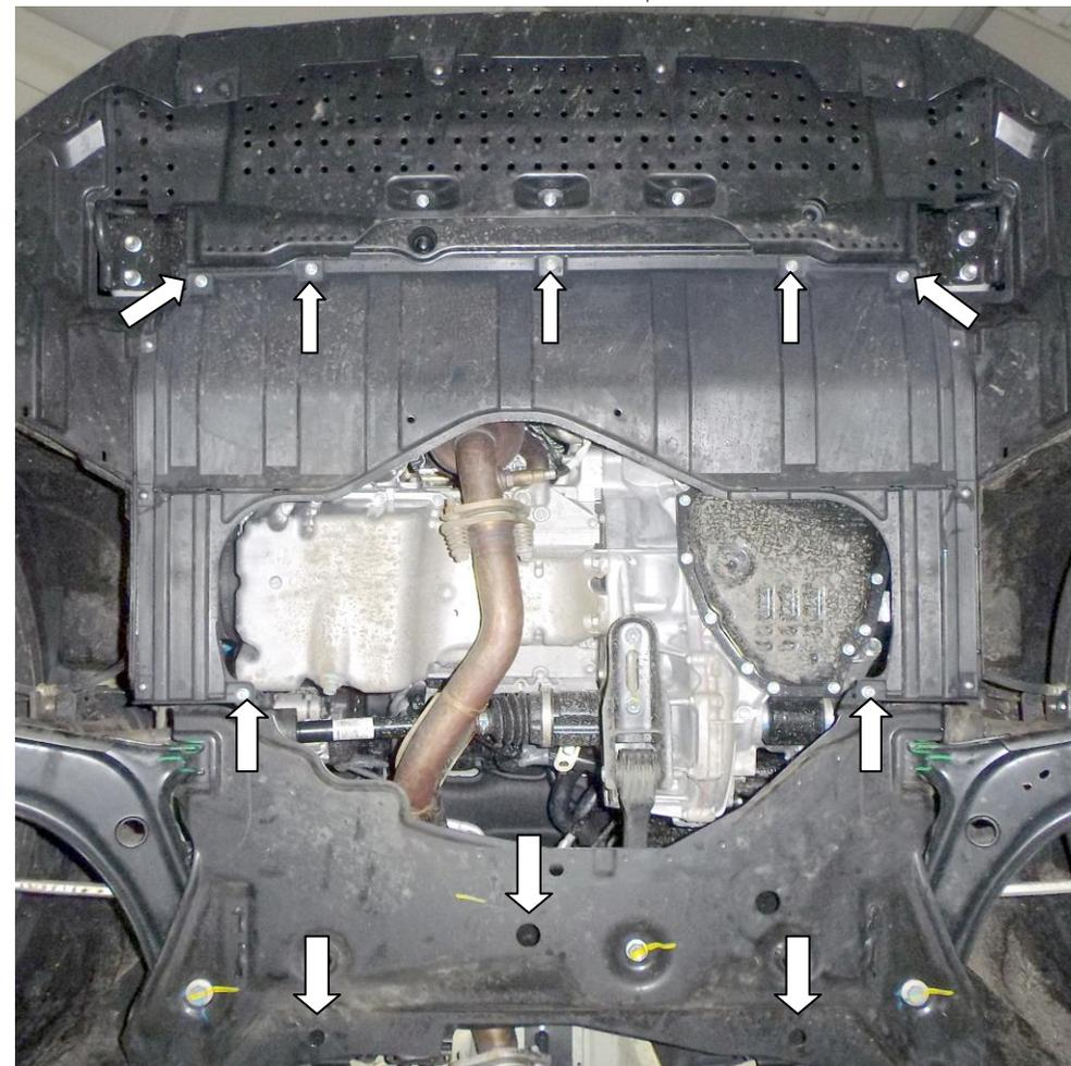
1. Снять штатный пластиковый пыльник, рис.1.
