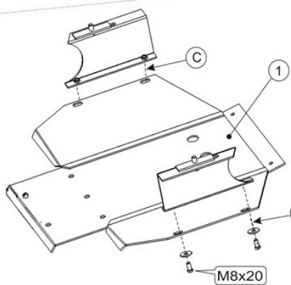
**4.**Установить защитные крылья прикрепив их к установленным планкам болтами M 10x30 -(A), причём правое крыло развернуть как показано на рисунке.
