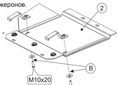
**3.**Установить закладные планки SD2002 в отверстия лонжеронов.
